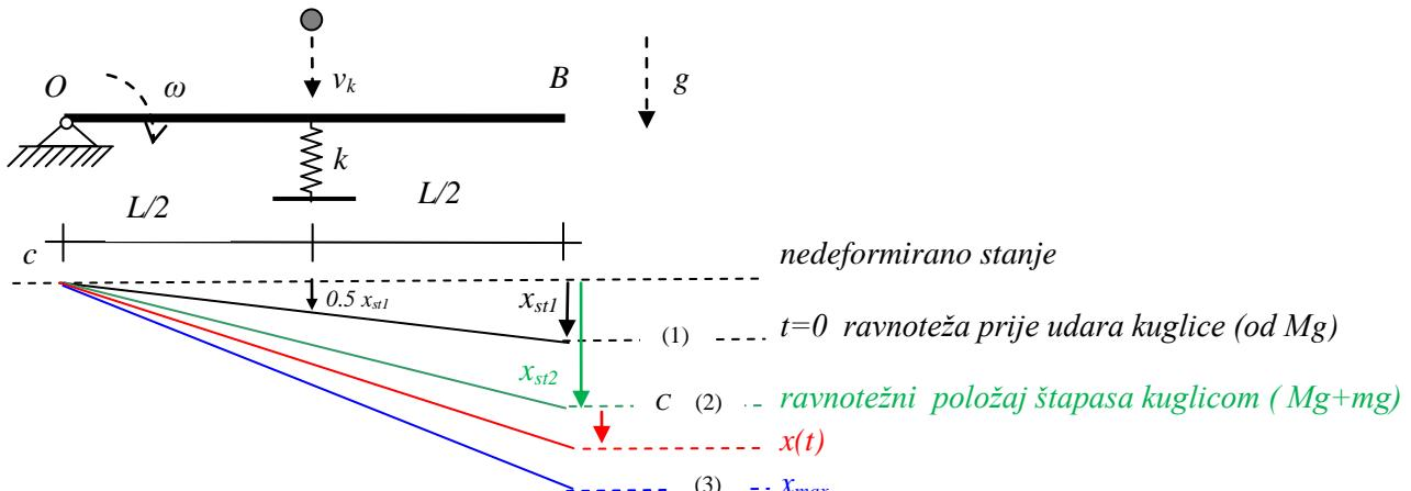
Odredimo deformaciju opruge prije udara kuglice, odnosno prvi ravnotežni položaj štapa bez kuglice.
