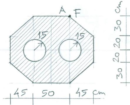
3. Za zadani tankostijeni presjek prikazan na slici treba odrediti središte posmika, ako je debљina stijenke  $t = 4 \text{ mm}$ .
