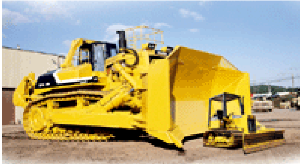
Slika 5.1.2. tzv. "U"- zatvoreni nož dozera (veliki dozer lijevo), tzv. "SU"- poluzatvoreni odnosno poluravni nož dozera (desno) i tzv. "S" ravni nož dozera (mali dozer lijevo)
