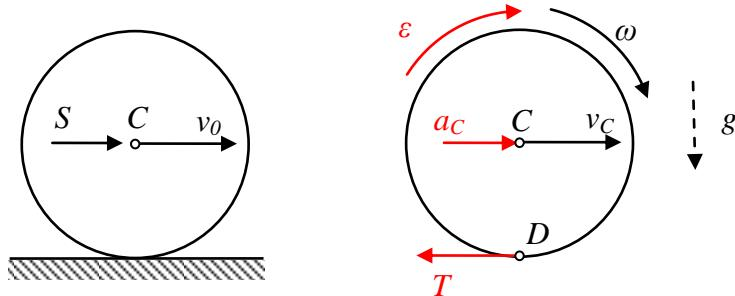
Gibanje tijela u općem slučaju rastavlja se na translaciju centra mase i rotaciju oko centra mase. Ako postoje neki spojevi dodaju se pripadne reakcije u spojevima i jednadžbe ograničavanja gibanja koje uvodi pojedini spoj.
