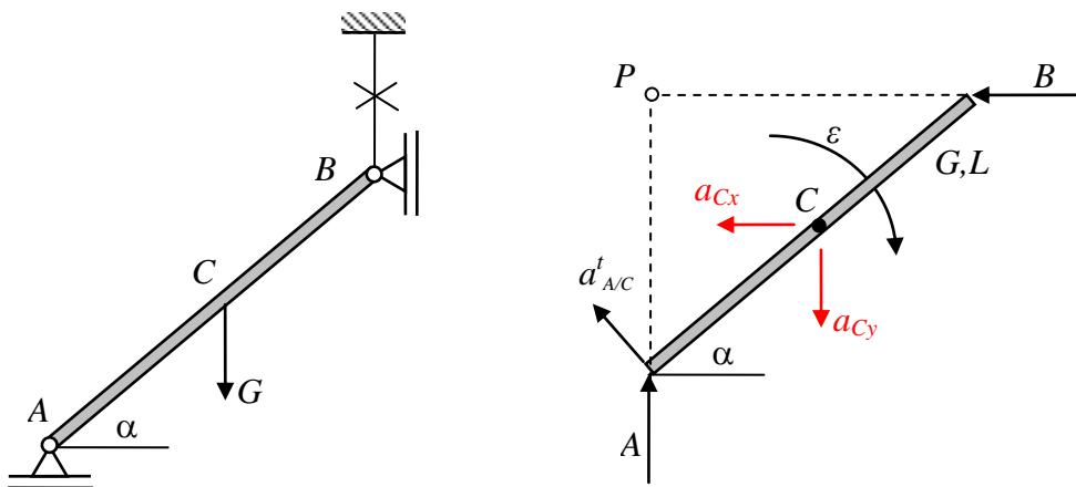
Gibanje tijela u općem slučaju definirano je translacijom centra mase i rotacijom oko centra mase. Ako postoje neki spojevi dodaju se pripadne reakcije u spojevima i jednadžbe ograničavanja gibanja koje uvodi pojedini spoj. U ovom slučaju dodaju se sile A i B.
