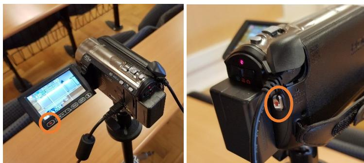
Slika 6. Snimanje se pokreće pritiskom na crveni gumb (●) ispod ekrana (lijevo) ili s desne strane pozadine kamere (desno)
