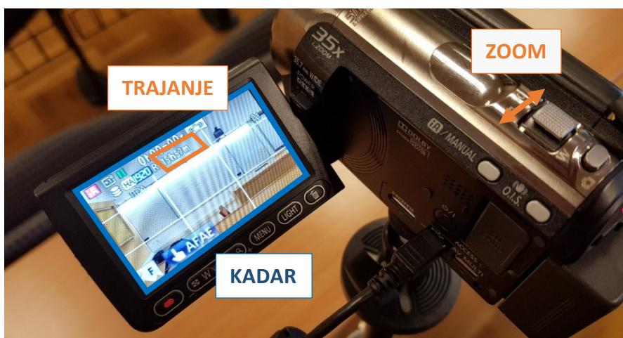
Slika 5. Na LCD ekranu potrebno je provjeriti je li ploča u kadru (kao na slici), po potrebi koristiti ZOOM da se postigne pravilan kadar, postoji li dovoljno memorije za snimanje (u primjeru 15h 57min)
