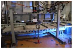
Slika 5. Spregnuti nosač CG1: 400\_C25\_CW10\_SP10 tijekom ispitivanja
