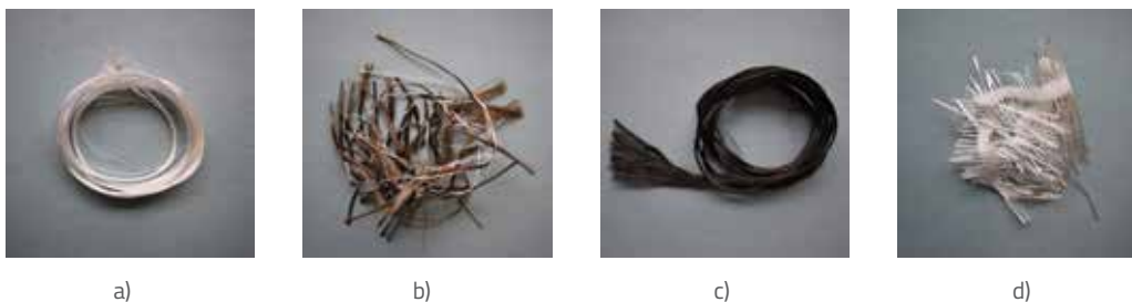
Otpadna vlakna iz proizvodnje visokovrijednih tekstila za građevinsku industriju: a) staklena vlakna – kraj namotaja, b) bazaltna vlakna – ostatak iz proizvodnje, c) ugljična vlakna – kraj namotaja, d) staklena vlakna – ostatak iz proizvodnje
