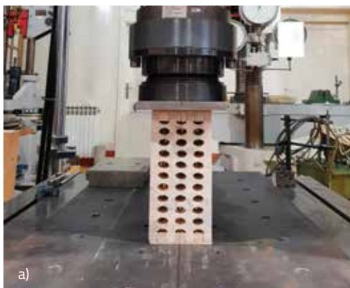
Inovativni lijepljeno-lamelirani drveni elementi: a) elipsasta prošupljenja; b) kružna prošupljenja
