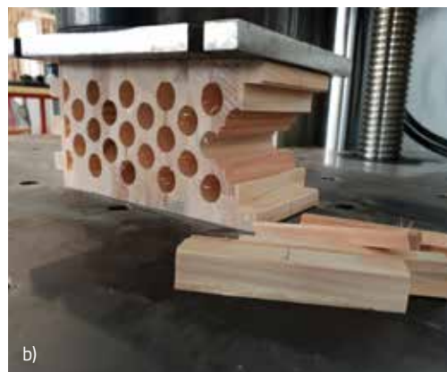
Inovativni lijepljeno-lamelirani drveni elementi: a) elipsasta prošupljenja; b) kružna prošupljenja
