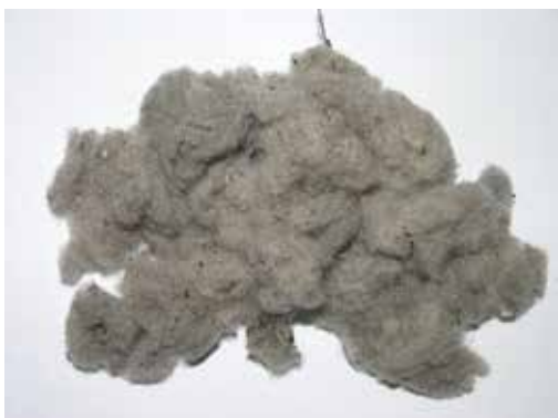
Reciklirana polimerna vlakna iz otpadnih guma
