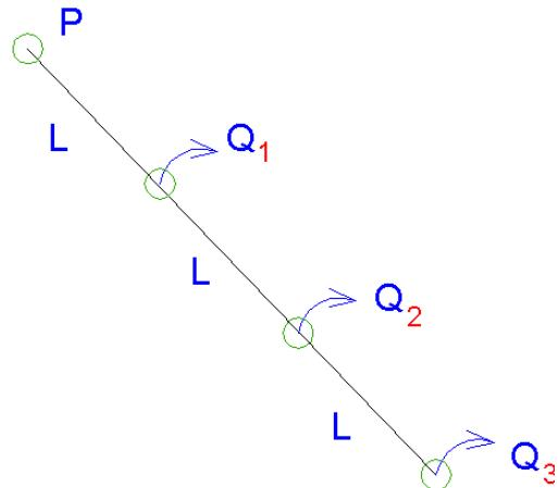
4. Vodonosnik pod tlakom, debljine propusnog sloja  $M = 10 \text{ m}$  i koeficijenta propusnosti  $k = 0,001 \text{ m/s}$  omeđen je u jednom smjeru sa vertikalnom nepropusnom granicom kao na slici. Paralelno sa nepropusnom granicom postavljena su tri zdenca jednakih izdašnosti  $Q = 0,01 \text{ m}^3/\text{s}$ . Potrebno je odrediti sniženje u piezometru  $P$  ako je radijus utjecaja zdenaca  $R = 3,5L$ ;  $L = 350 \text{ m}$ .
