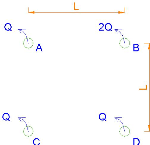
7. Za vodonosnik pod tlakom potrebno je izračunati sniženje razine podzemne vode u zdencu  $A$  ako se iz zdenaca  $A, B, C, D$  crpe količine kao na slici.
