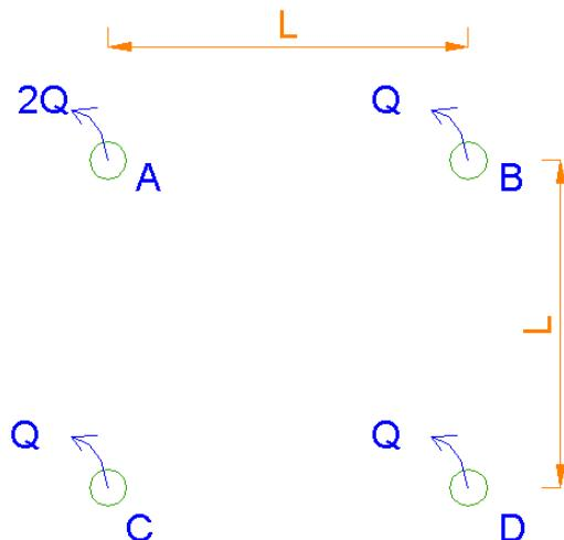
$$s_A = \frac{2Q}{2\pi kM} \ln \frac{R}{r} + 2 \frac{Q}{2\pi kM} \ln \frac{R}{L} + \frac{Q}{2\pi kM} \ln \frac{R}{\sqrt{2}L} = 2,91 \text{ m}$$
