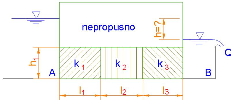
$$v_1 = v_2 = v_3 = \frac{Q}{A} = \frac{0,005}{3 \cdot 4,5} = 0,00037 \text{ m/s}$$
