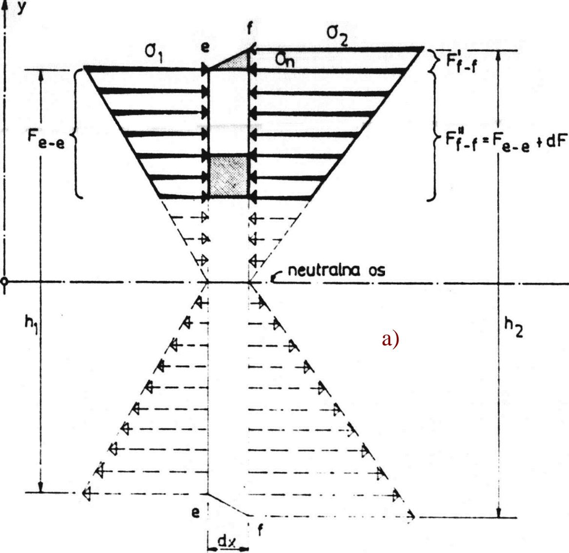
Izdvojeni element LLN sa dvije kose izvodnice istog nagiba (sl.a; sl.b - bliski vertikalni presjeci e-e i f-f )
