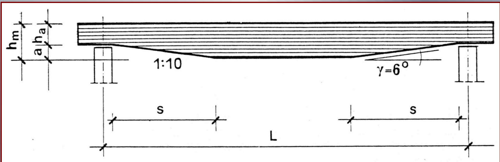
Promjena visine poprečnog presjeka kosim zasijecanjem na ležaju nosača
