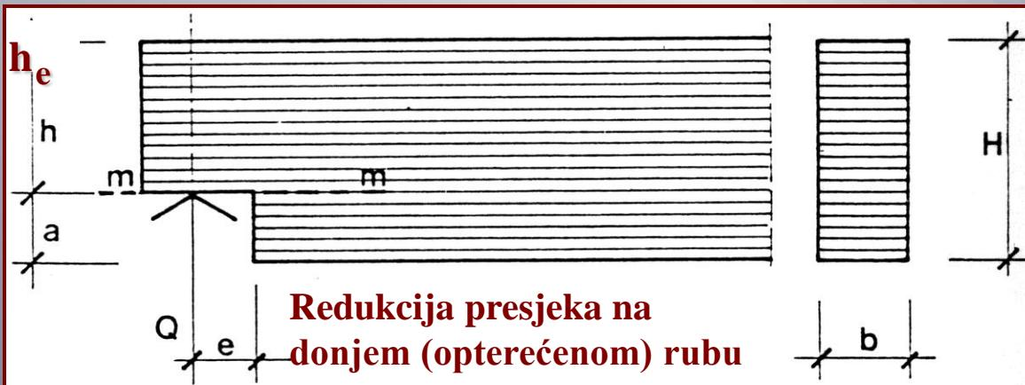
Duljina redukcije mora se ograničiti na vrijednost  $e \leq 0.4 \cdot H$  da bi se kontrola nosivosti mogla provesti sa reduciranom vrijednosti dopuštenog naprezanja na posmik kod savijanja:
